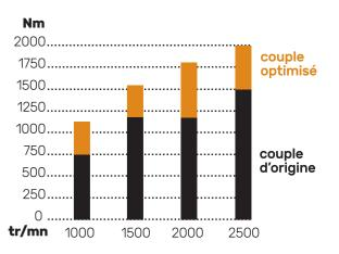
L'AUGMENTATION DU COUPLE MOTEUR PERMET À LA FOIS D'AMÉLIORER LE RENDEMENT MOTEUR ET D'AUGMENTER LA VITESSE ET LA QUALITÉ DE TRAVAIL.
