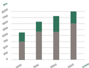
L'optimisation de la cartographie permet de développer sensiblement le couple moteur et de le décaler au bon régime d'utilisation afin d'augmenter le rendement moteur.
