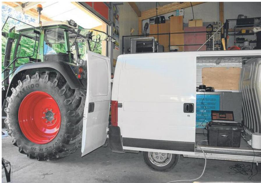
Le passage au banc de puissance se fait avant et après la mise au point.
