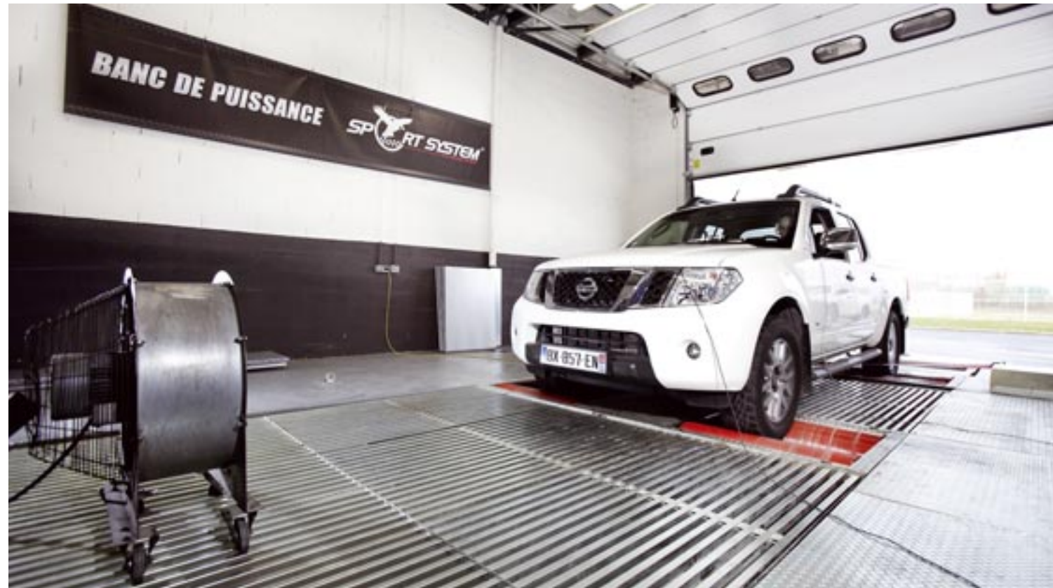
Le banc de puissance "4 roues motrices" permet de développer sur place les cartographies optimisées par les quatre ingénieurs motoristes de la société qui dispose également d'un banc "6 roues" pour poids lourds unique dans sa précision et sa puissance. Même l'UTAC, référence dans le domaine, ne dispose pas d'un tel outil !
